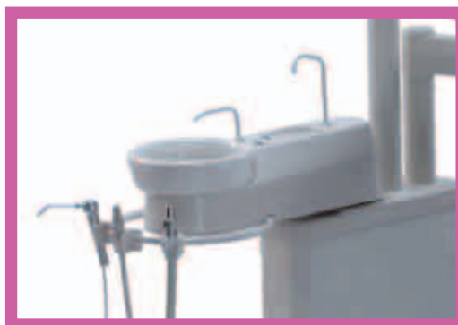
1-568 CRACHOIR US-P.A.S+ASPI+S+BOX Jet de verre, Cuvette en céramique Temporisation de l'eau de la cuvette, 1 Porte canule pompe à salive 1 Porte canule d'aspiration, 1 Collecteur d'aspiration Sélection automatique des supports avec Mâchoire de fixation sur tube 2" (50,8 mm) Boîte sous crachoir Fixation sur colonne 2"
