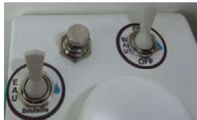
Mettre le bouton sur «on» pour la mise en pression de la bouteille. Choix entre eau de ville et eau de bouteille\*.
