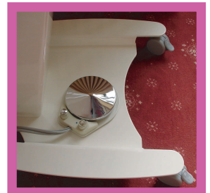
Pédale disque pneumatique avec marche/arrêt du spray et chip blower Foot control with wet/dry and chip blower
