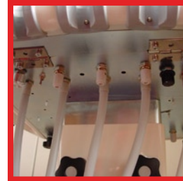
Réglage des sprays et micro moteur sous la tête (potentiomètre et inverseur facile d'accès)
