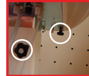
Boutons pour le réglage de la hauteur et des boutons d'ouverture du carquois
